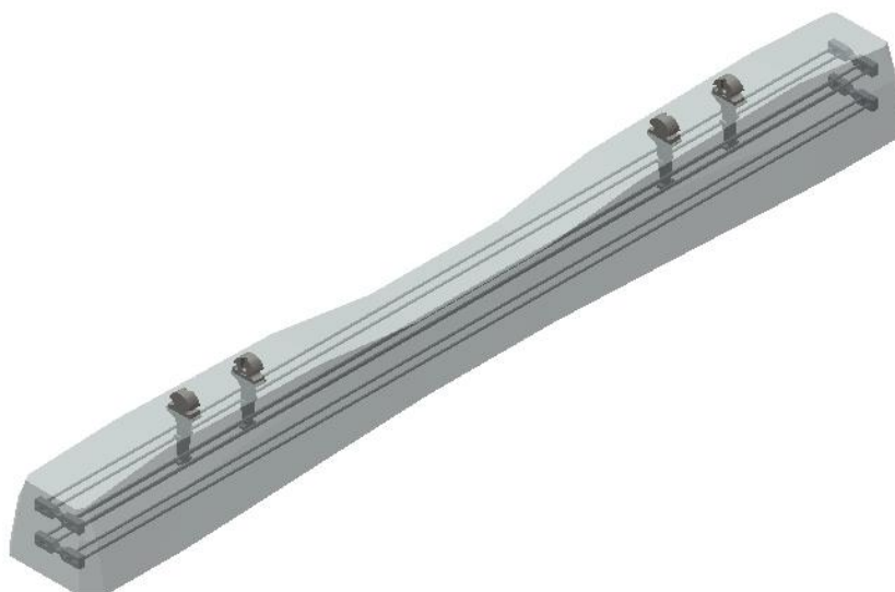
Rysunek 1a. Podkład strunobetonowy PS-94 z uwidocznionym zbrojeniem sprężającym
